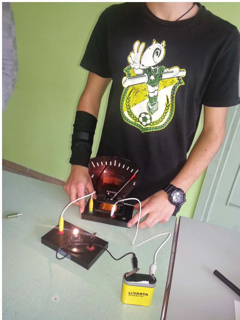
Un circuito con pila, lampadina, amperometro
